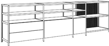
Korpus und Rückwände müssen aus Stabilitätsgründen bei jedem zweiten Element eingebaut werden.
