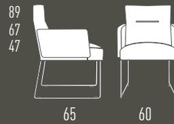
Polsterstuhl ohne Armlehne. Mit rundem Stahlrohrgestell. Sitzbereich mit dauerelastischem Gewebe bespannt und Schaumteil konfektioniert. Sitz und Rücken gepolstert und bezogen. Kunststoffgleiter – Filzgleiter optional. Ausführungen gemäß Preisliste.
